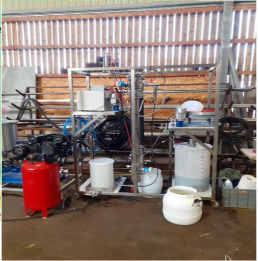
PROCEDE DE STRIPPING DE L'AZOTE
